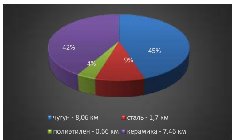
Рис.6 – Структура канализационных сетей по материалам (п. Постоянный)
