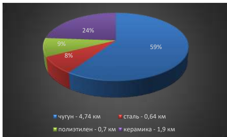
Рис.7 – Общая структура канализационных сетей по материалам (Калтанский городской округ)
